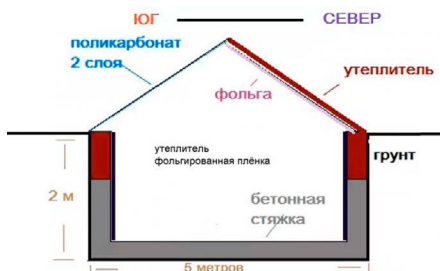
СХЕМА СТРОИТЕЛЬСТВА ТЕПЛИЦЫ-ТЕРМОСА
